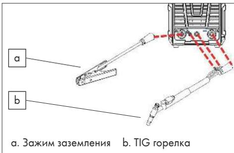
а. Зажим заземления б. TIG горелка
