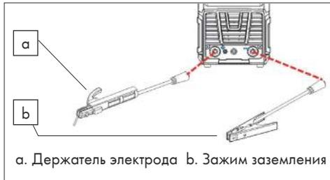
а. Держатель электрода б. Зажим заземления
