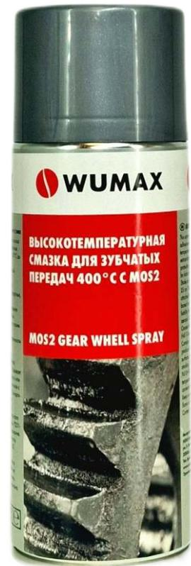
**Применение:** Удалить остатки старой смазки с помощью промышленного очистителя, в случае очень сильного загрязнения - щеткой или шпателем. **Перед применением необходимо сильно встряхивать баллон, до тех пор, пока не услышите свободное движение смешивающего шарика (около 1 минуты).** Распылите с расстояния примерно 25 см. **Повторяйте встряхивание перед каждым распылением.** В зависимости от площади и места использования, этот процесс следует повторять через определенные промежутки времени.
