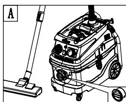
Пылесос является многофункциональным, обладает функцией двойного всасывания, с передним и верхним всасывающим отверстием.
