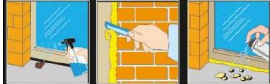
Однокомпонентная полиуретановая монтажная пена обладает высокой адгезией к большинству строительных материалов: бетон, кирпич, дерево, металл и т.д., за исключением полиэтилена, полипропилена и т.п. Обеспечивает хорошую термо- и звукоизоляцию.
